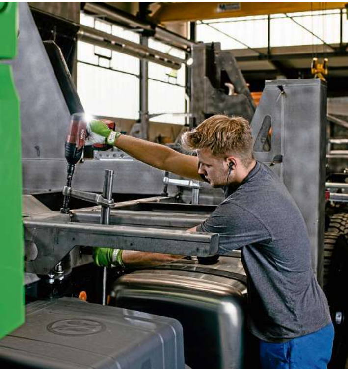
Ein Mitarbeiter bereitet in der Produktionshalle das Chassis eines Lkw für die Aufnahme von Ventilations- und Materialcontainer vor.
