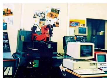
Das 1988 in Betrieb genommene „CAX-Labor“ mit grafisch-dynamischen Programmierarbeitsplätzen und CNC-Fräs- und -Drehmaschinen (oben) sowie dem kleinen flexiblen Fertigungssystem mit dem verfahrenbaren Mitsubishi-Industrieroboter (unten).
