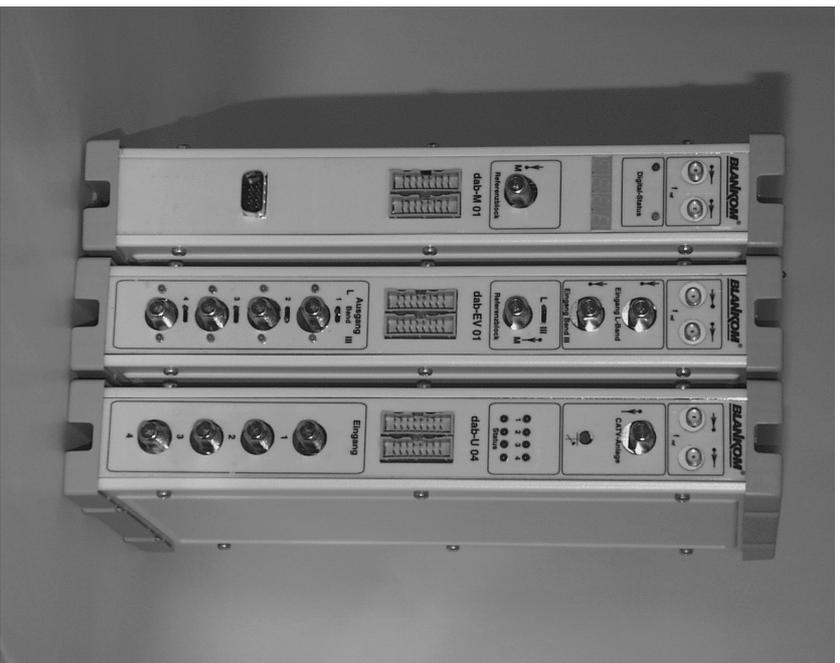
Bild 6: DAB-Umsetzer für bis zu vier Blöcke
