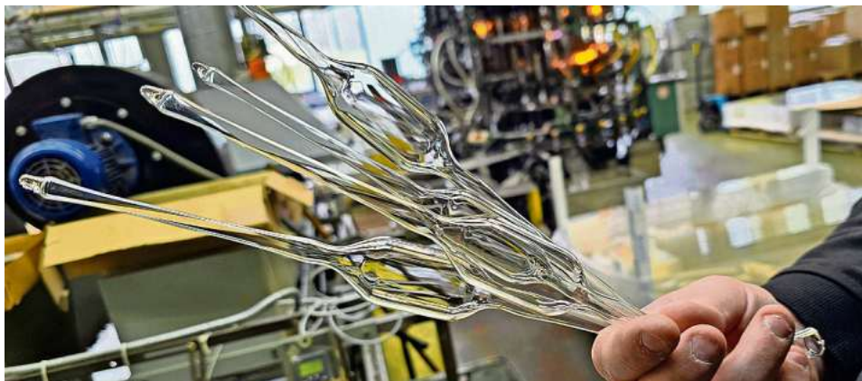
Ohne Glaskolben keine Christbaumkugeln. Das Rohmaterial frisch gefertigt am Standort des Betriebes „Glasverarbeitung Gösselsdorf“.
